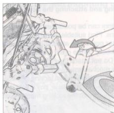
Присоедините подножку Bumprider к соединителям, которые вы установили на коляску и защелкните замки. Пожалуйста, отрегулируйте высоту кронштейна указанным выше способом, затем убедитесь, чтобы **подножка была строго параллельна поверхности пола**. Затяните винты по обе стороны регуляторов подножки. Перед использованием Вы должны убедиться, что системы блокировки и винты хорошо заперты и закручены.
