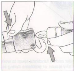
Отсоедините телескопические кронштейны от зажимов для фиксации подножки к коляске нажатием на кнопку освобождения в верхней части кронштейна, откройте крючок и освободите зажим с ремнем для фиксации.
